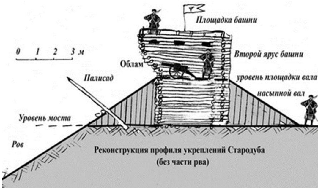
Рис. 4. Реконструкция профиля укреплений Стародуба
